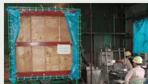
<日鉄住金鋼板 社内動風圧試験>
