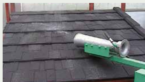
<日鉄住金鋼板 社内水密試験>
